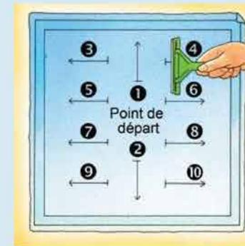
Découpez le film en laissant **1 à 2 mm entre le joint de la vitre et le film** (pour éviter que le film talonne le joint après le marouflage).
