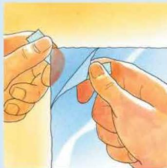
Tout en retirant le liner, **humidifiez abondamment le film afin de neutraliser la colle**, vous pourrez positionner votre film avec facilité et précision.
